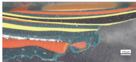
写真28 研ぎ出しによる試作犀皮文様の塗膜断面（反射光）
